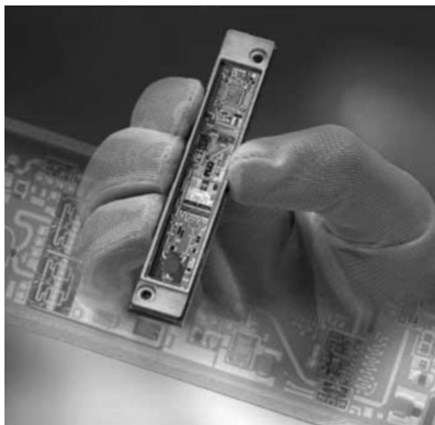
Рис. 11.2. Внешний вид приемно-передающего модуля АФАР компании Cassidian
